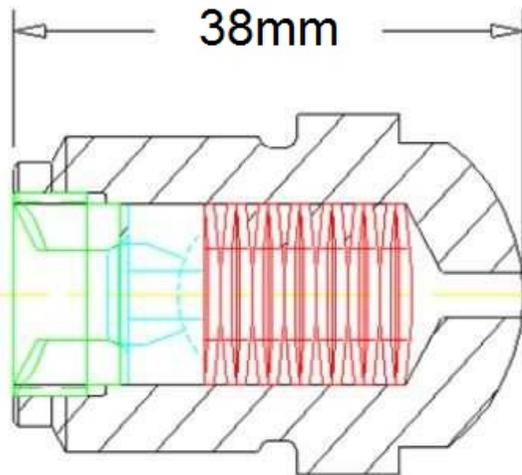
1. L'embout est livré monté : **il est constitué de 4 éléments : le corps en noir, les rondelles belleville en rouge, l'obturateur en bleu et le siège en vert.** Le siège dépasse de quelques mm de l'entrée matière de l'embout avant le 1<sup>er</sup> montage.
