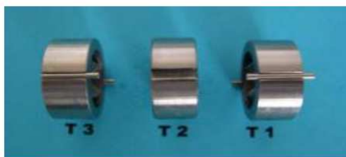
Photo 1 : 3 types d'éléments mélangeurs : T1, T2 et T3
