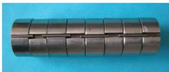
Photo 3 : Assemblage de huit (8) éléments mélangeurs NSM
