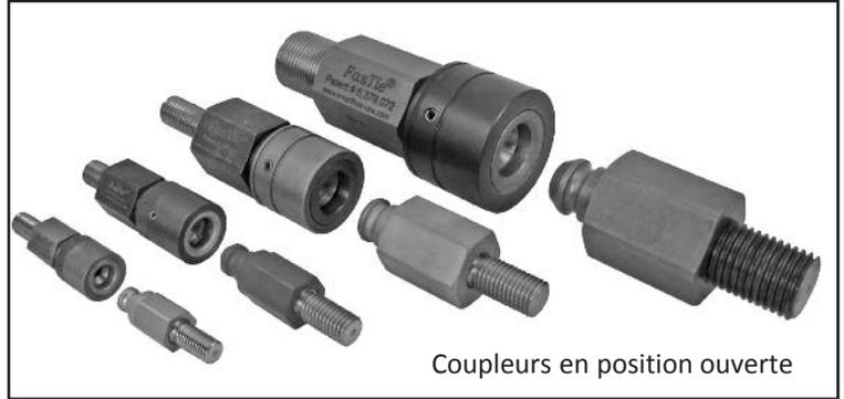
**Précaution d'usage :** Le coupleur femelle doit impérativement être en position ouverte avant d'être connecté à l'embout mâle. Voir figure 1. Des dommages sur le coupleur résulteront d'un non respect de cette consigne. Ne pas faire fonctionner la presse à injecter avec des coupleurs en position ouverte !
