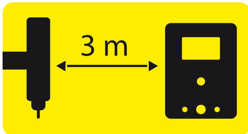
La distance entre le poste piggyWelder® et une autre source de soudure au TIG ou tout autre appareil de soudure à allumage haute tension doit être au minimum de 3 mètres.
