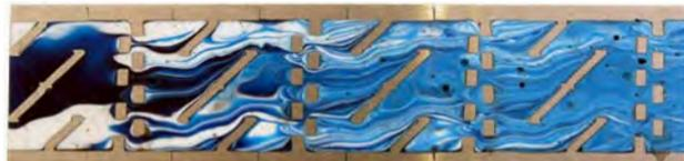
Le mélangeurs haute performance X-Grid offre une qualité d'homogénéisation identique à ceux des mélangeurs statiques standard avec une longueur plus courte.
