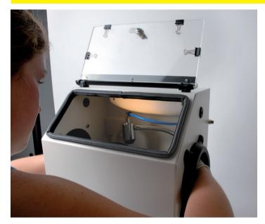
Une petite cabine complète avec buse en carburedetungstène de 4mm.Bon éclairage et construction robuste.
