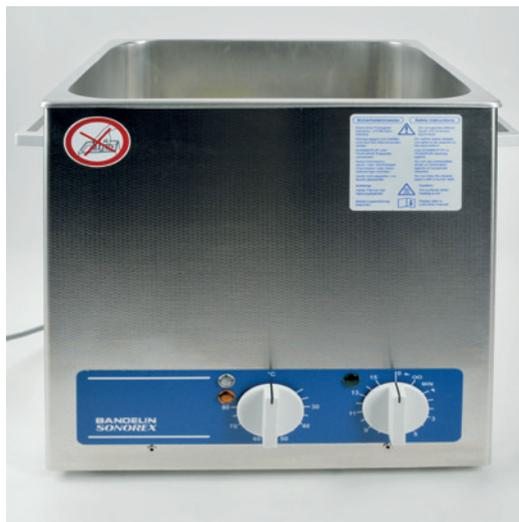
La taille de l'objet à nettoyer détermine la taille de la cuve et donc le type d'appareil requis.
