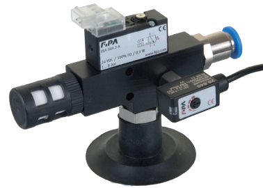
Exemple : mini vacuostat 20.040 sur éjecteur venturi EBA.08H.2-A et ventouse plate Ø 40 mm
