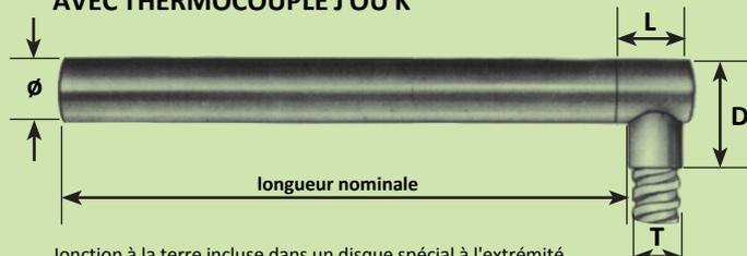
Jonction à la terre incluse dans un disque spécial à l'extrémité.
